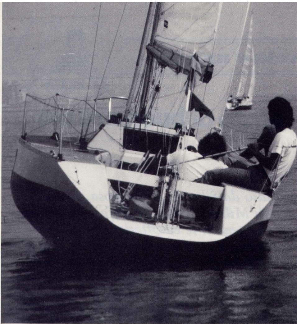
Lo specchio di poppa del Lupo. Rispetto ai prototipi sul nuovo Lupo è stato leggermente modificato il piano velico. Più grande la randa e più piccolo il fiocco nei primi, più equilibrio fra randa e fiocco nel secondo. L'armamento rimane a 3/4. Anche la distribuzione dei pesi è stata modificata, in particolare nel bulbo.
